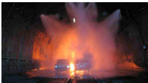
Obr. 18 – Zkouška hasicí schopnosti MHZ v silničním tunelu [17]
