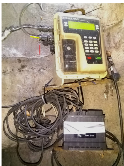
Obrázek 36: Hach Sigma 950 pro měření průtoku před OK na náměstí [fotografie autorky]
