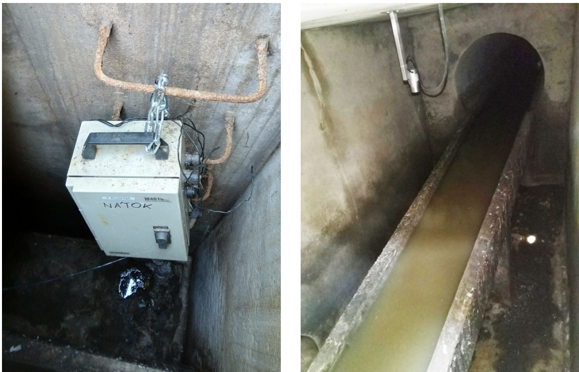
Obrázek 39: Fiedler M4016 pro měření hladiny v OK u tvrže [fotografie autorky]
