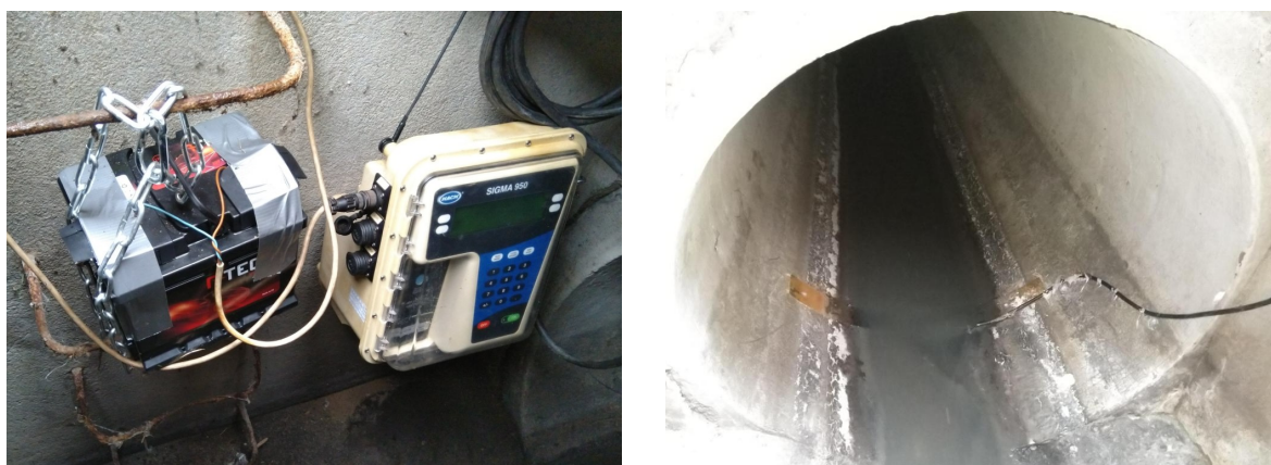
Obrázek 42: Hach Sigma 950 pro měření průtoku jednu šachtu před OK u tvrže [fotografie autorky]
