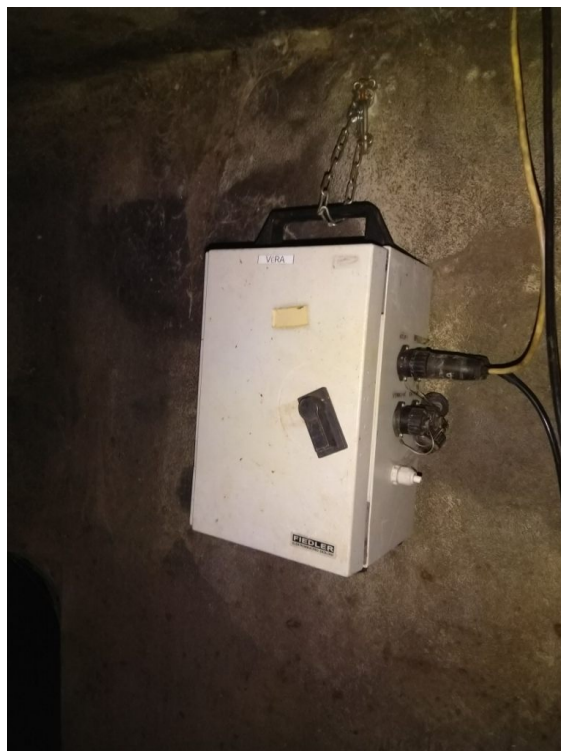
Obrázek 33: Fiedler M4016 pro měření hladiny v OK u náměstí [fotografie autorky]
