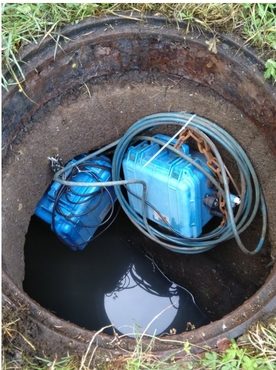
Obrázek 53: Nivus Nivuflow mobile 750 pro měření průtoku před spojnou komorou u areálu TOS Čelákovice [fotografie autorky]
