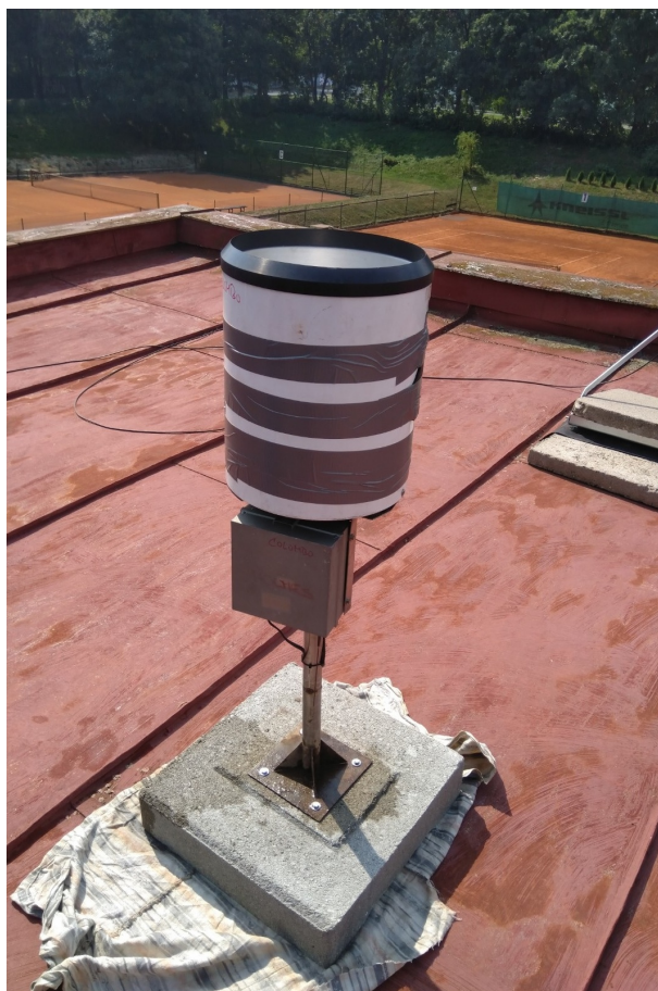
Obrázek 56: Osazený srážkoměr na střeše klubovny [fotografie autorky]
