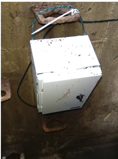
Obrázek 26: Fiedler Q2 pro měření hladiny v OK u ČOV [fotografie autorky]
