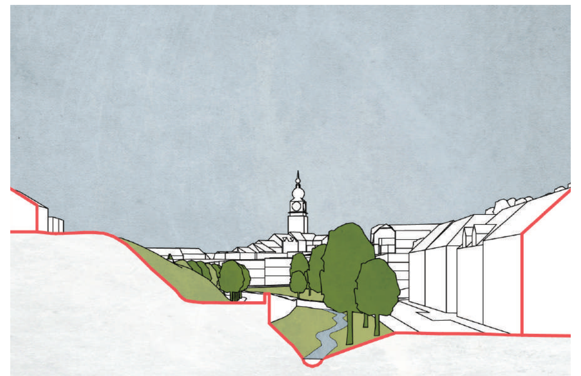
(3) Řez stoupající silnicí a zklidněnou ulicí Na Potoce vedoucí na nižší úrovni kolem potoka.
