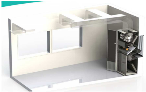
Obr. 10 Umístění lokální VZT jednotky
