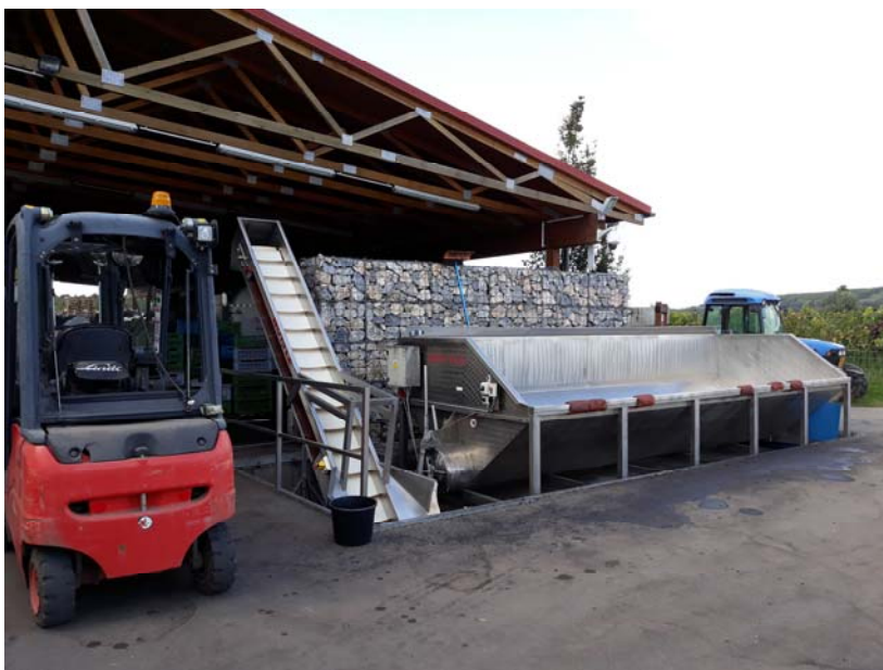
Obr.8: Vlevo ješterka, vpravo příjmová vana s pásovým dopravníkem [foceno: 26.9.2019, Vinařství Šlechtitelka, Velké
