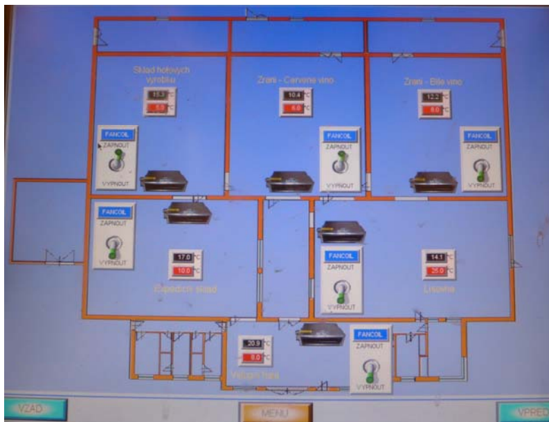
Obr.24: Řídicí obrazovka – ovládání fancoilů [foceno: 26.7.2019, Vinařství Šlechtitelka, Velké Pavlovice]
