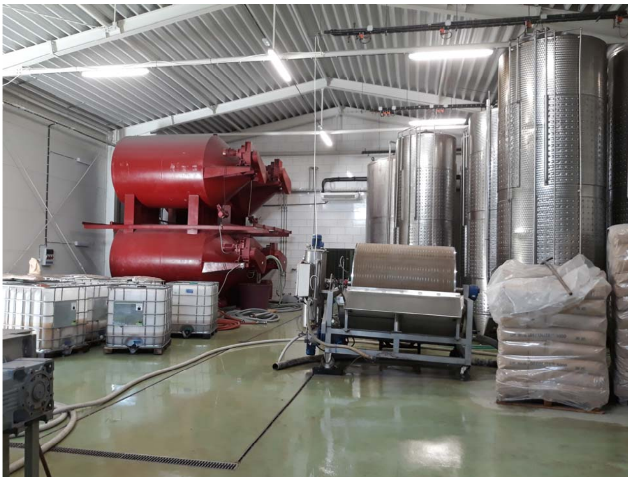
Obr.40: Lisovna – vlevo vinifikátory, vpravo nerezové tanky [foceno: 11.10.2019, Vinařství ANNOVINO, Lednice]
