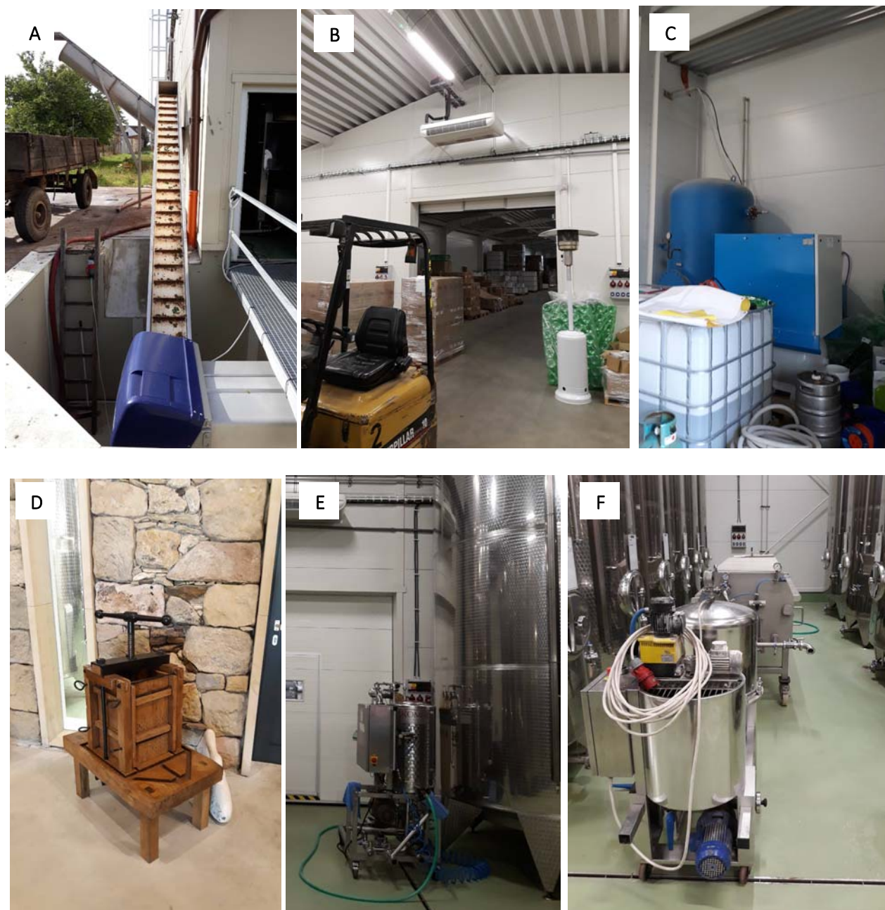
Obr. 43: A – Pásový dopravník z mlýnkoodštopkovače, B – Expedice, C – kompresor s nádobou na stlačený vzduch pro plnicí linku, D – Starý lis - vintéka, E – crossflow filtr, F – vpředu mobilní Cip stanice a vzadu filtr [foceno: 11.10.2019, Vinařství ANNOVINO, Lednice]
