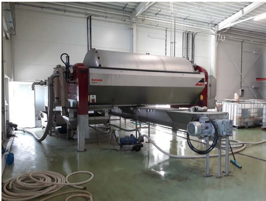
Obr.41: Lisovna – lis o objemu 8000 litrů [foceno: 11.10.2019, Vinařství ANNOVINO, Lednice]
