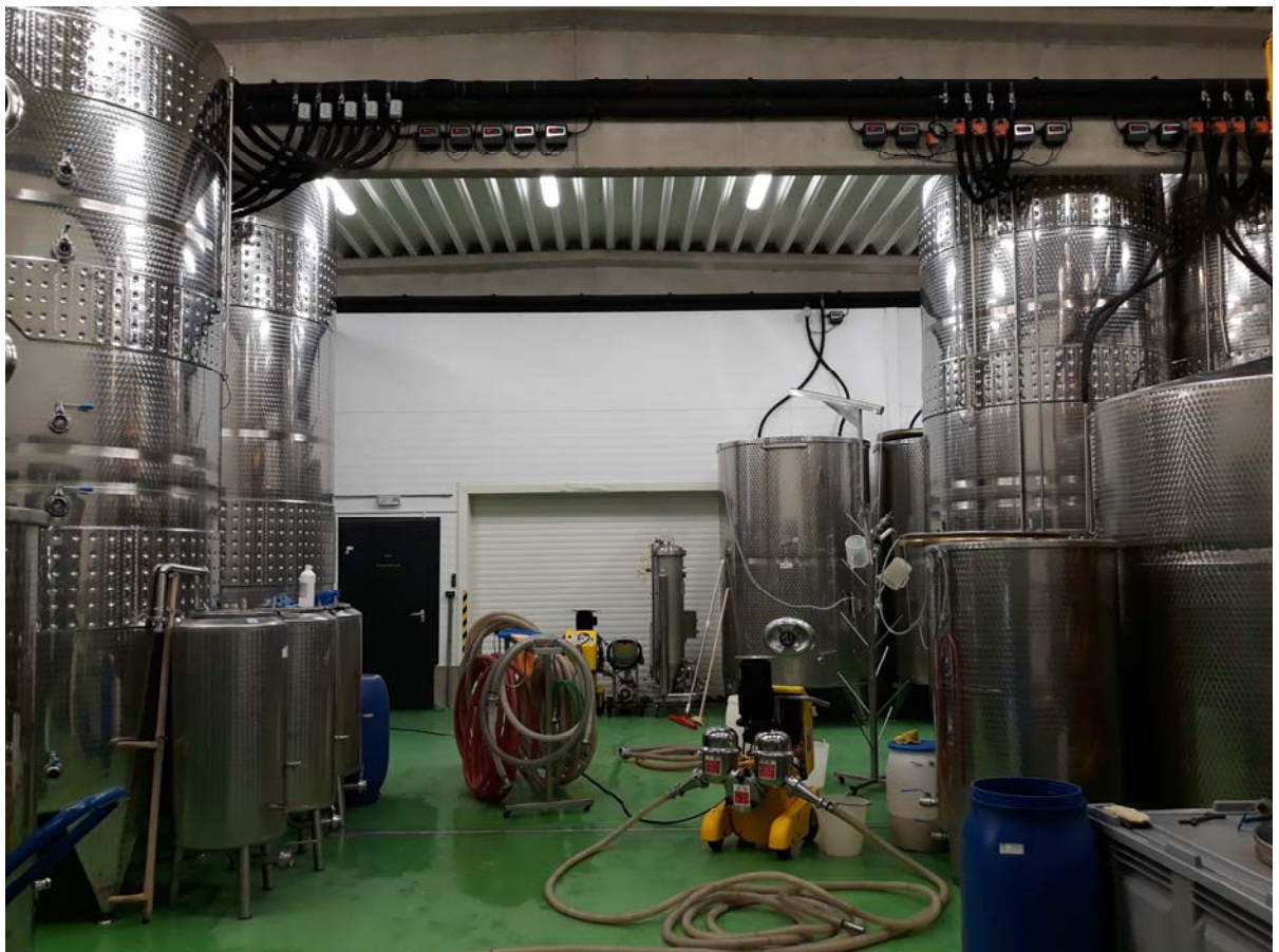
Obr. 3: Napojení tanků na systém řízené fermentace [foceno: 28. 11. 2019 Vinařství Volařík, Mikulov]
