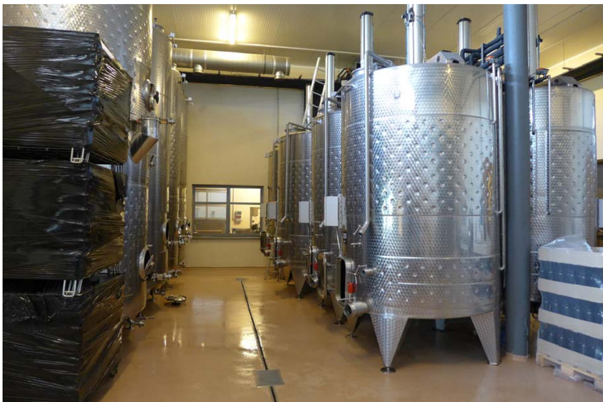
Obr.10: Lisovna – vlevo vinifikátory [foceno: 26.7.2019, Vinařství Šlechtitelka, Velké Pavlovice]
