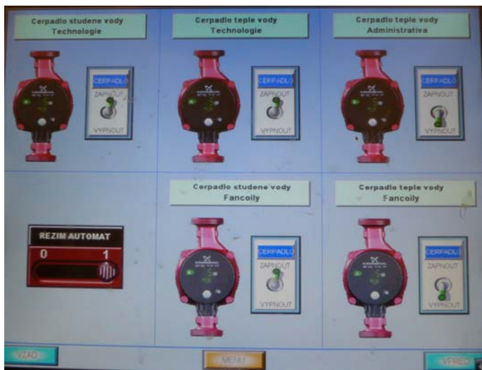
Obr.34: Řídicí panel umožňující ovládání jednotlivých oběhových čerpadel [foceno: 26.7.2019, Vinařství Šlechtitelka, Velké Pavlovice]
