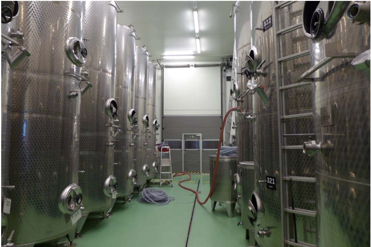
Obr.7: Nerezové tanky - zrání červeného vína [foceno: 26.9.2019, Vinařství Šlechtitelka, Velké Pavlovice]
