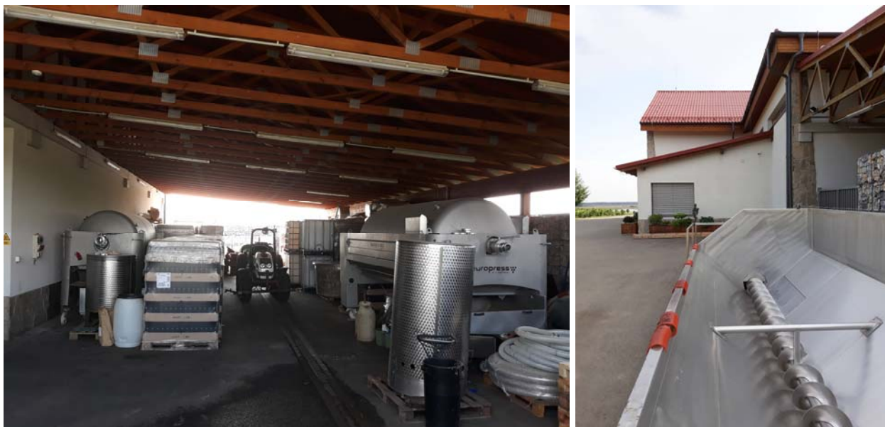
Obr.9: Vlevo Příjmová hala, vpravo šnekový dopravník [foceno: 26.7.2019, Vinařství Šlechtitelka, Velké Pavlovice]
