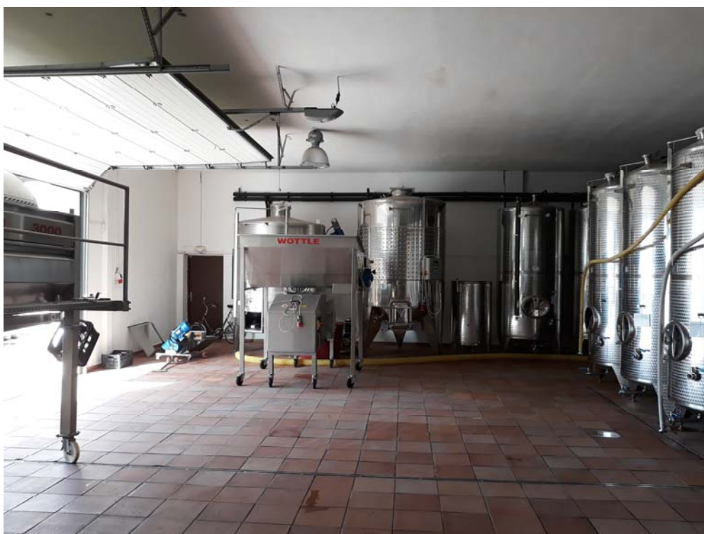
Obr.51: Příjmová vana s mlýnkoodzrňovač a nerezové [foceno: 10.11.2019, Vinařství Nikolsburg, Mikulov]
