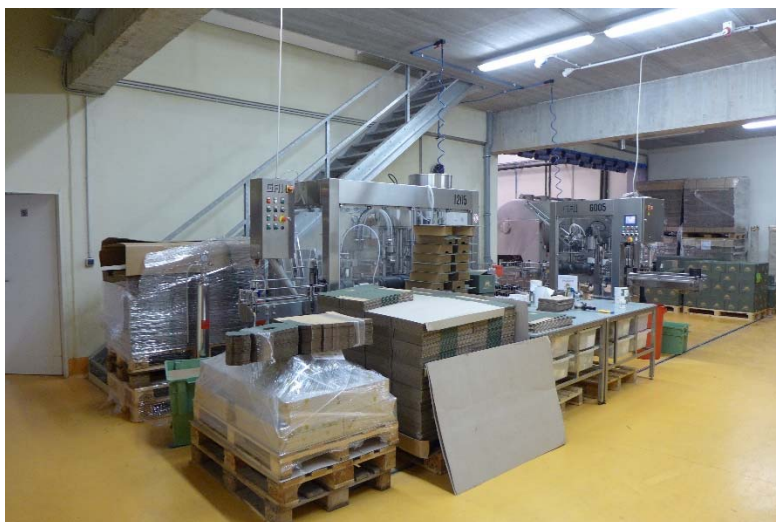
Obr. 9: Lahvovací a etiketovací linky - vinařství Sonberk [foceno: 29.11.2019, Vinařství Sonberk, Popice]
