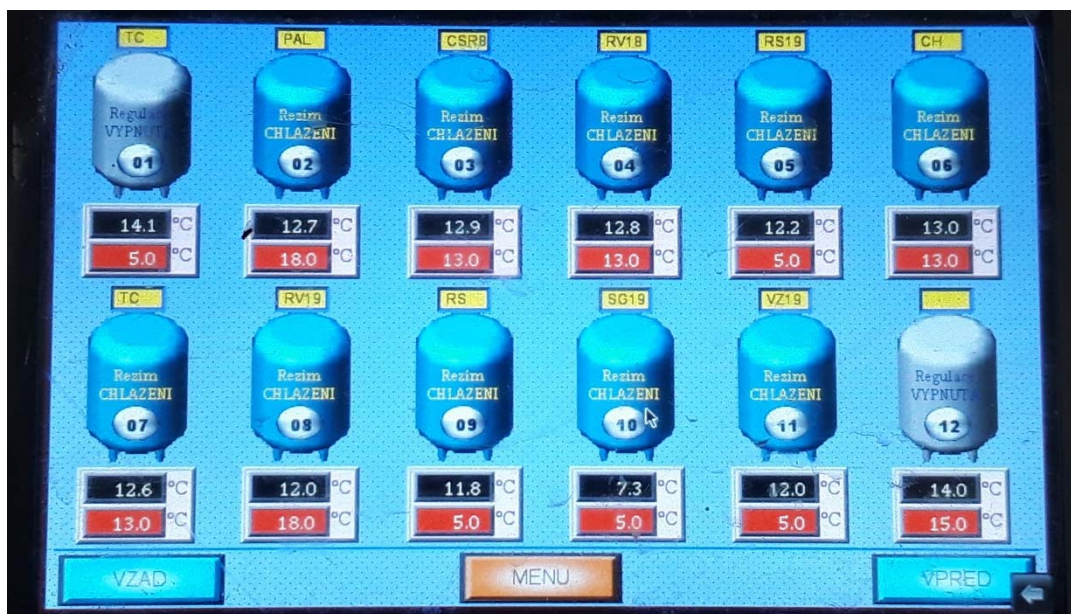
Obr. 12: Fotografie řídicí obrazovky – řízená fermentace [foceno: dne 11.10.2019, místo: Vinařství Nikolsburg, Mikulov]
