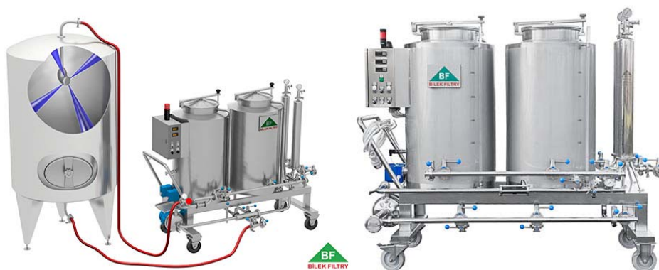
Obr. 13: Animace sanitační stanice s instalovanou vystřikovací hlavicí v tanku [17]
