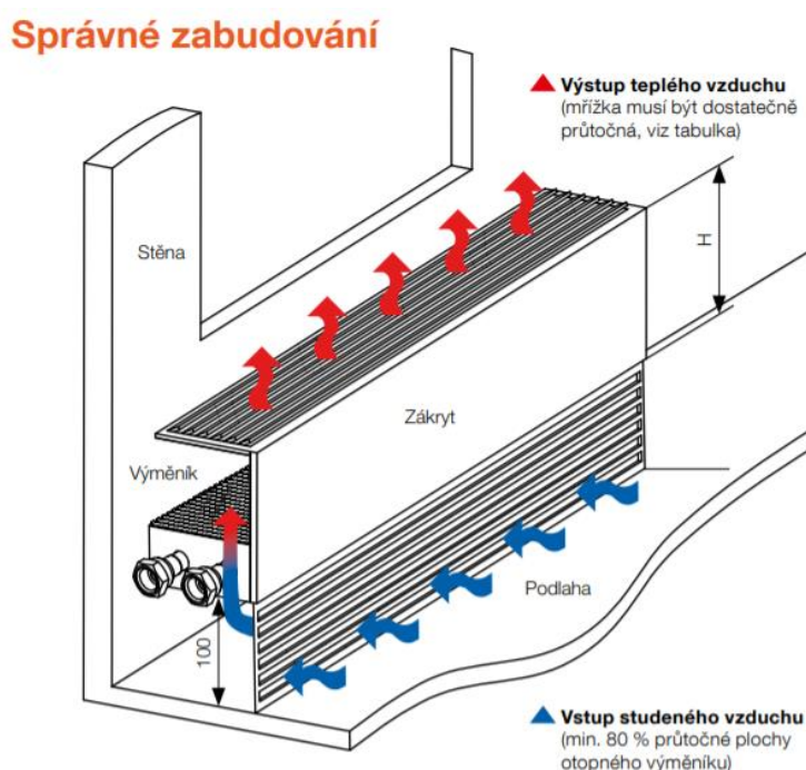
Obr. 1: Způsob zabudování výměníku Korabase [44]
