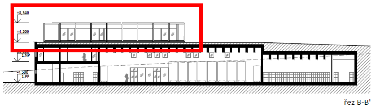
Obrázek 3: Vyznačení dřevostavby objektu – řez B-B' [11]
