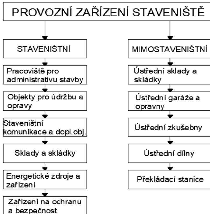
Obrázek 3: Schéma členění provozního ZS (5 str. 122)
