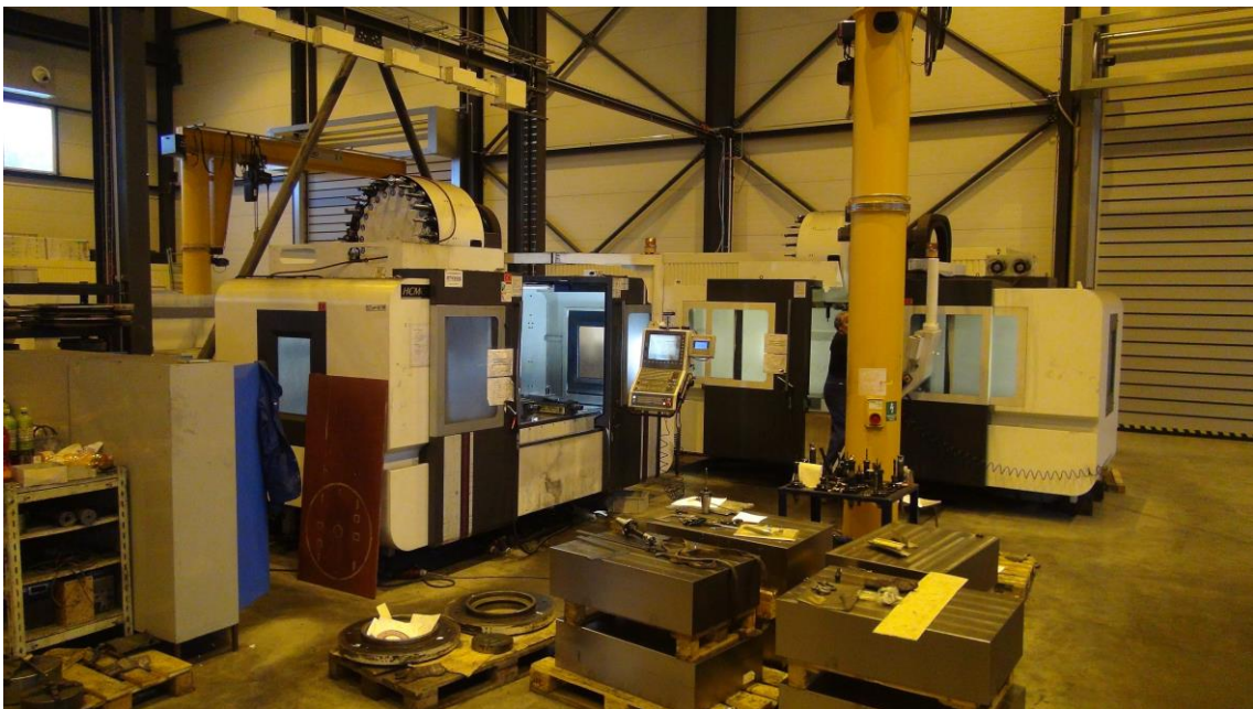
Obrázek č. 9. – CNC obráběcí centra se sloupovými jeřáby
