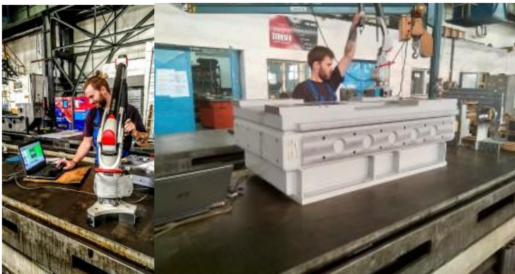
Obrázek č. 10. – Kontrola jakosti výrobku pomocí měřícího ramene ROMER 7525
