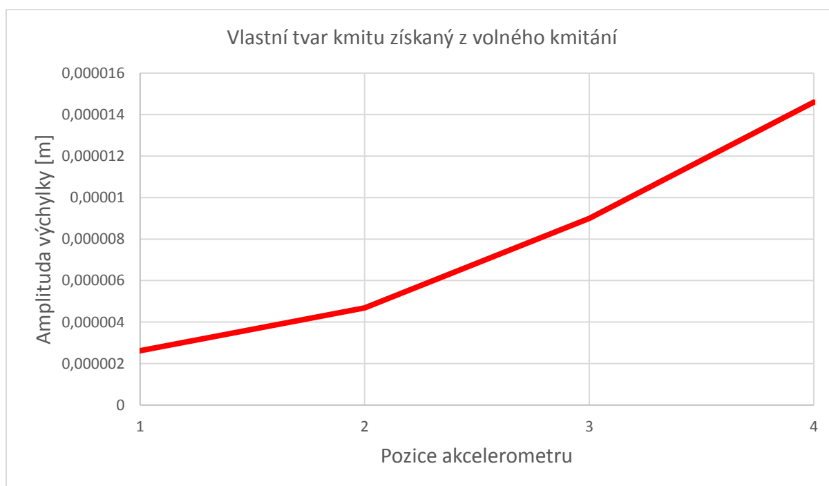
Obrázek 56 - Vlastní tvar kmitu získaný z volného kmitání
