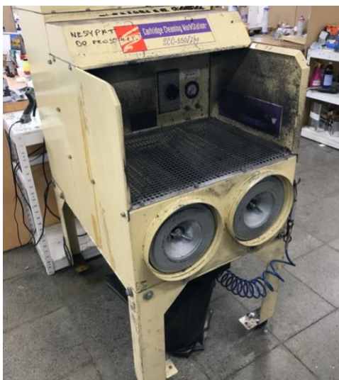
Obrázek 7: Čisticí zařízení Cartridge Cleaning Workstation SCC-550/2hp [Zdroj: Vlastní tvorba, 2019]
