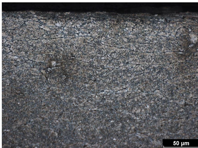
Obrázek B 22: Struktura povrchu litého polotovaru po 40 % deformace, příčný řez
