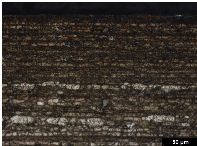
Obrázek B 11: Struktura povrchu lisovaného polotovaru po 20 % deformace a TZ, podélný řez
