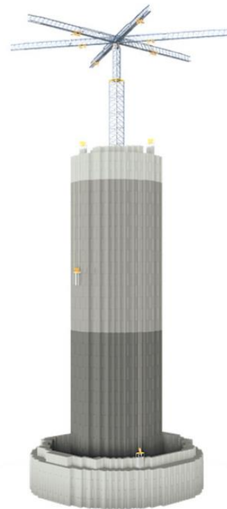
Obrázek 5: Systém skládání panelů gravitačního skladování energie [15]
