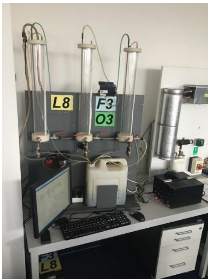
Obr. 1: Laboratorní model Soustava tří nádob
