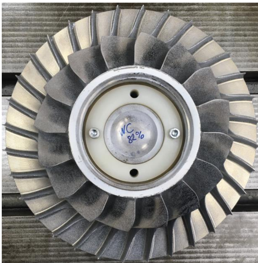
Obrázek 85: Test pokrytí karbidovými kuličkami
