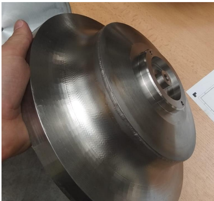
Obrázek 73: Svaření vany a horního víka
