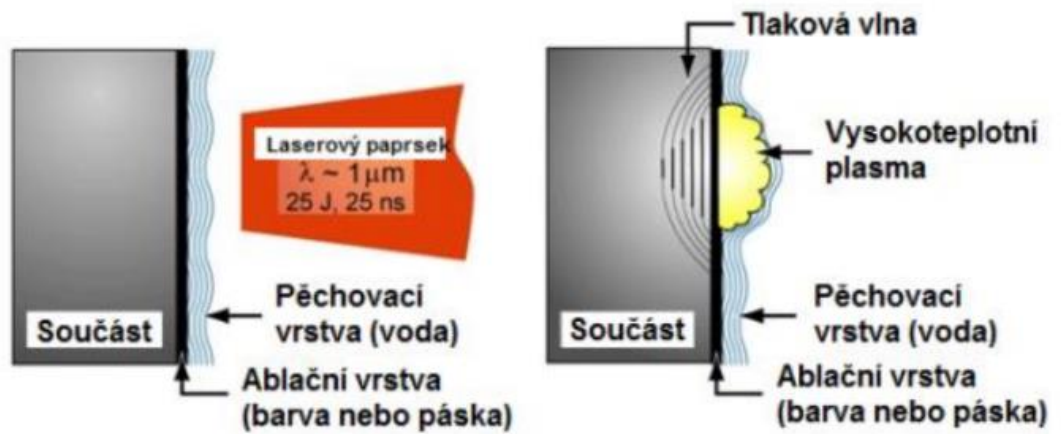
Obrázek 17: Princip technologie laser peening [7]
