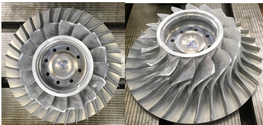
Obrázek 83: Výsledek testu pokrytí po obou cyklech
