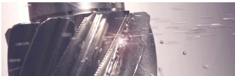
Obrázek 8: Zpevňování povrchové vrstvy zubů frézy pomocí řízeného kuličkování [5]
