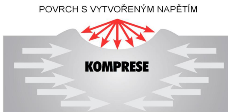
Obrázek 9: Princip pevnění povrchu kuličkováním [4]
