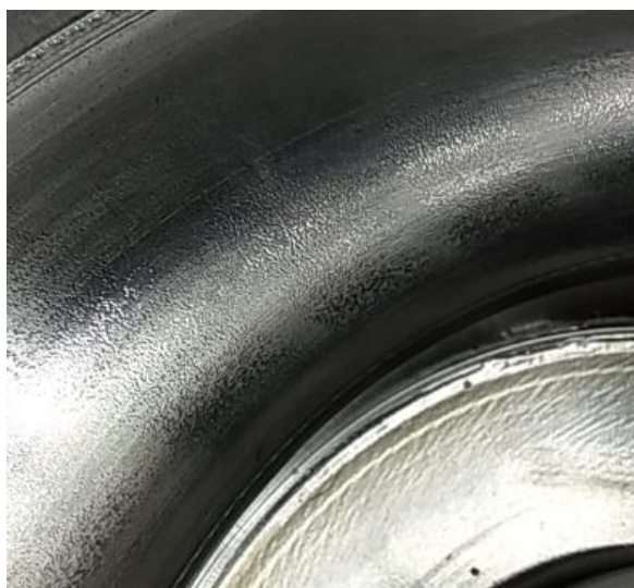
Obrázek 82: Stopy kuliček patrné po zpevnění přípravku
