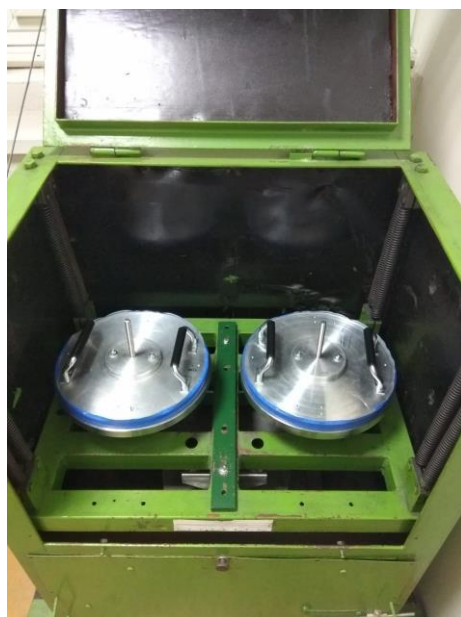
Obrázek 31: Vibrační rám s přípravky, vibrační motor je umístěn pod rámem
