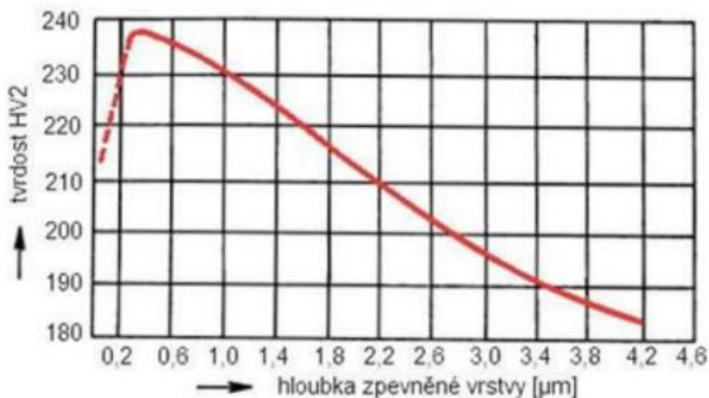
Obrázek 19: Závislost hloubky zpevněné vrstvy na tvrdosti [12]
