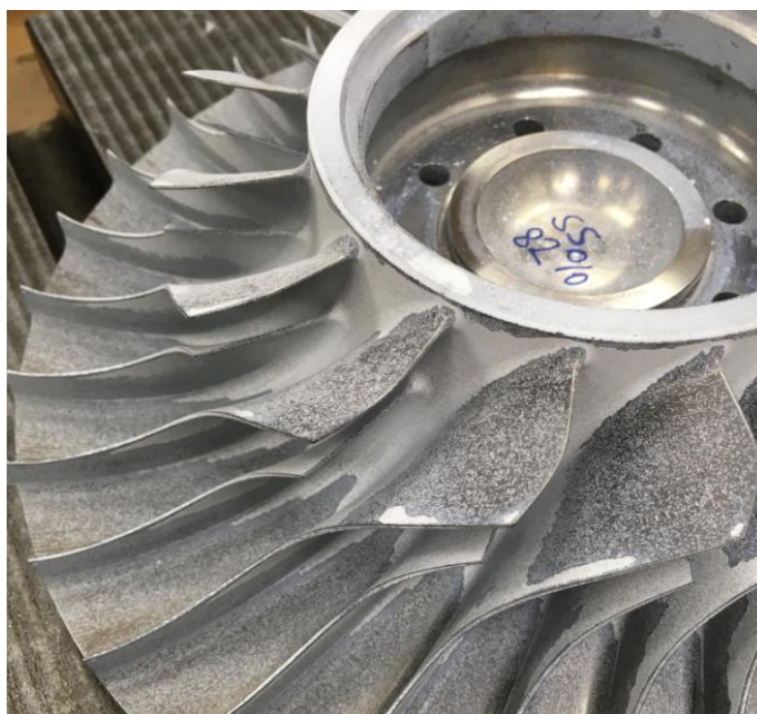
Obrázek 84: Detail testu pokrytí nerezovými kuličkami
