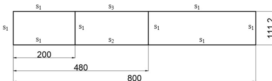
Obrázek 9.4 Rozměry řezu kontrolního nosníku
