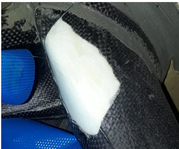
Obr. 13 Příprava kopyta na laminaci
