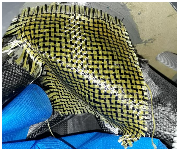
Obr. 14 Laminace vstupního kanálu
