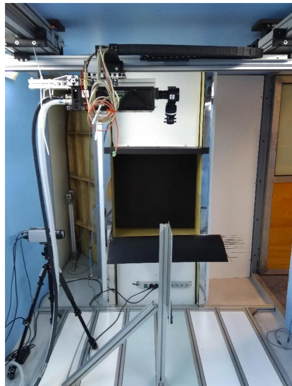
Obr. 26 — Křídlo umístěné v aerodynamickém tunelu. Pohled zezadu.
