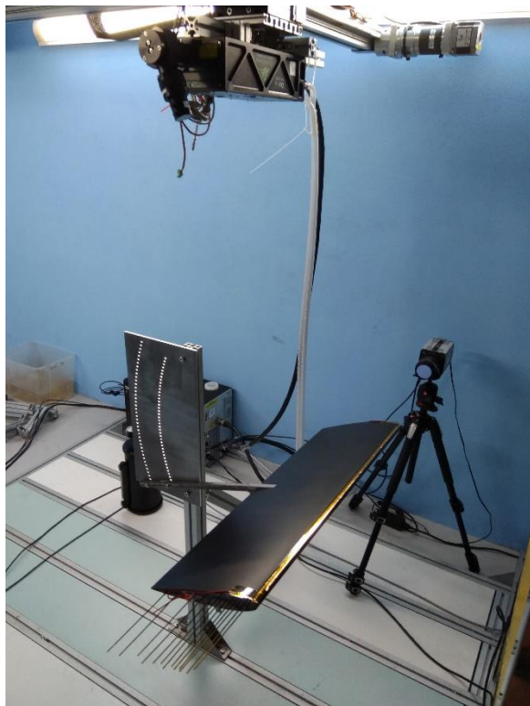
Obr. 25 — Křídlo umístěné v aerodynamickém tunelu. Pohled z boku. Na stropě tunelu je uchycen laser, u vzdálenější stěny je umístěná kamera.
