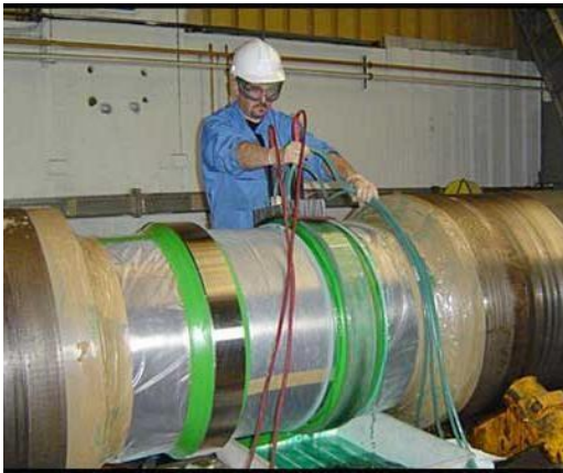
Obrázek 8 Použití technologie tampónování pro pokovení části hřídele [17].
