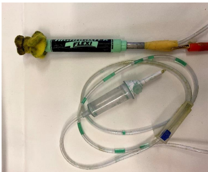
Obrázek 18 Pokovovací nástroj připojený na dávkovací zařízení.
