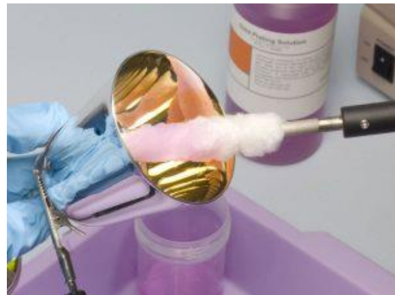
Obrázek 9 Použití technologie tampónování u malých dílů, pro nanesení povlaku z ušlechtilého kovu [18].
