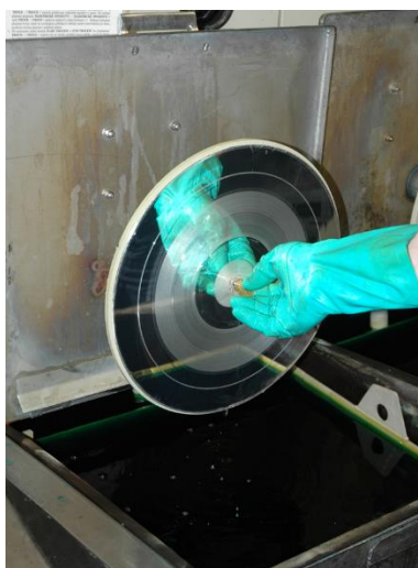
Obrázek 7 Matrice gramofonové desky vytvářena pomocí galvanoplastiky [14].
