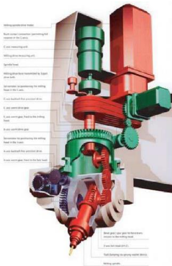
Obr. 46: Dvouosá frézovací hlava s mechanickým náhonem vřetena [1]
