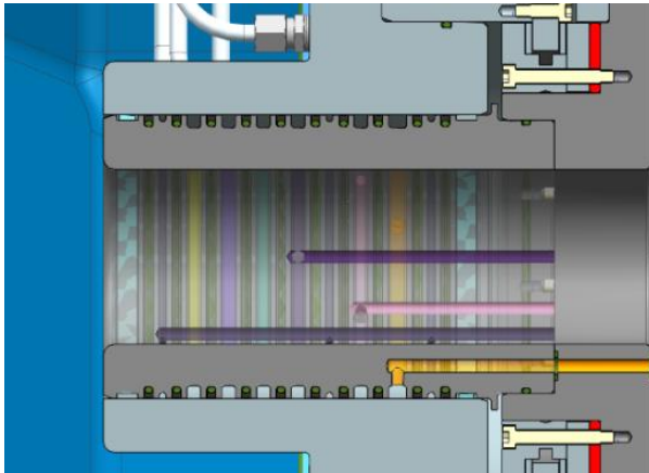
Obr. 93: Řez rotační rozvodkou
