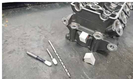
Obr. 22 – díly nutné k realizaci implementace tlakového snímače do hlavy motoru
