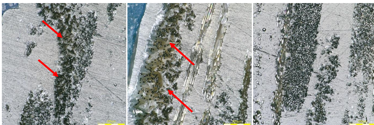
Obr. 52 Výbrus kompozitu z prepregů lisovaných za nízkého tlaku, objektiv 20x, všechny snímky v režimu BF
