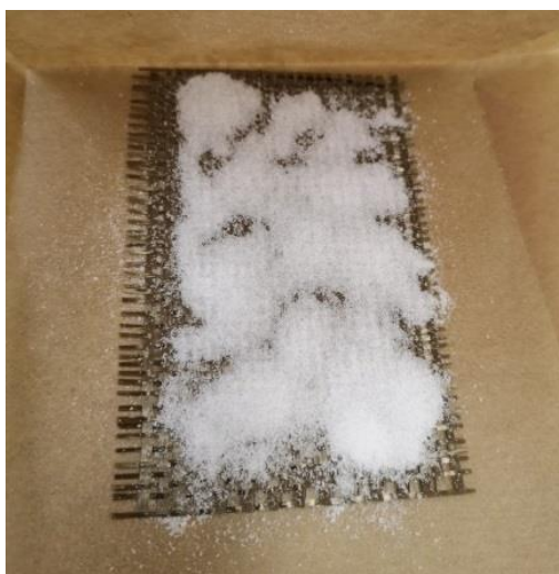
Obr. 44 Příprava před lisováním prepregu
