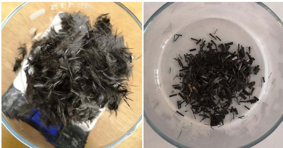
Obr. 37 Porovnání uhlíkových vláken, a) upravený stav, b) neupravený stav
