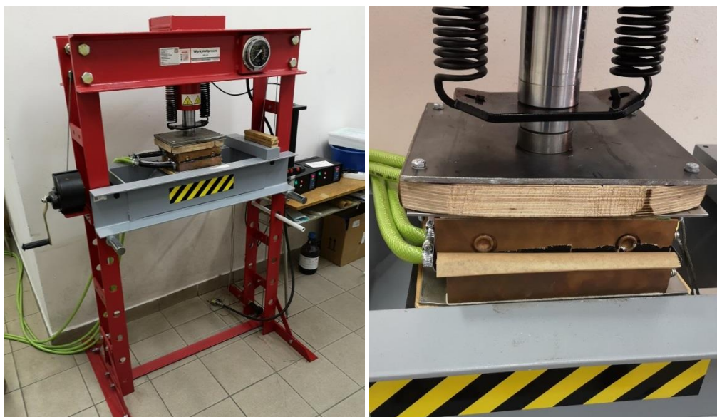
Obr. 23 a) hydraulický lis, b) vyhřívané desky
