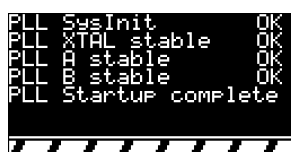
Obrázek 9.8: Obrazovka s informacemi o stabilitě jednotlivých částí PLL Si5351.
