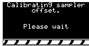
Obrázek 9.10: Probíhající autokalibrace stejnosměrné složky.
