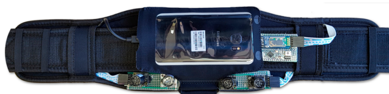
Obrázek 3.3: Opasek vybavený ultrazvukovými senzory a pouzdrém pro kameru vyvinutý na polytechnické univerzitě v Bukurešti [13]
