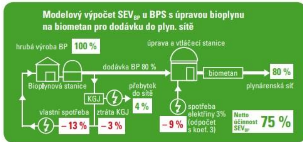
Obrázek 3.5 – Schéma výpočtu SEV_{BP} pro konfiguraci s technologií přepracování bioplynu na biometan. [53]
