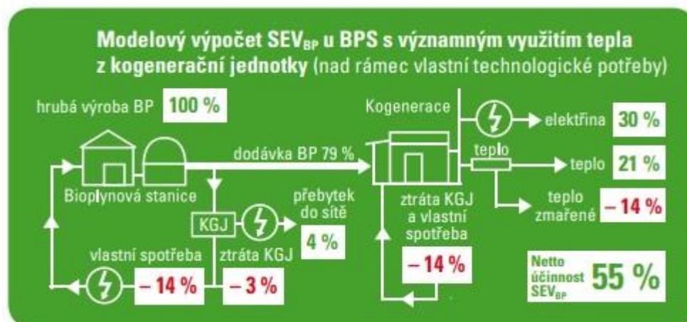
Obrázek 3.4 – Schéma výpočtu SEV_{BP} pro konfiguraci BPS s vyvedením tepla pro další energetické účely. [53]
