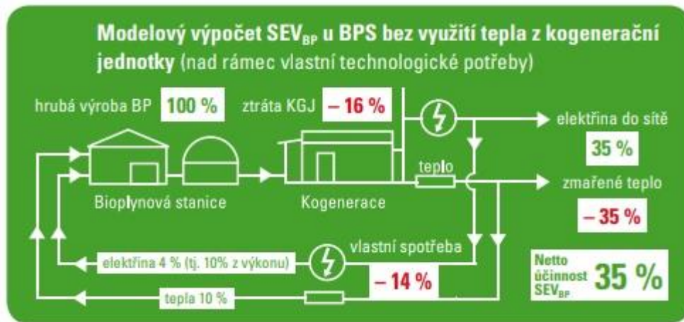
Obrázek 3.3 – Schéma výpočtu SEV_{BP} pro základní konfiguraci BPS. [53]
