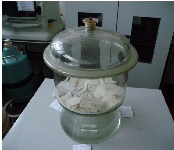
Obrázek 14 - Vlhkostní komora – exsikátor
