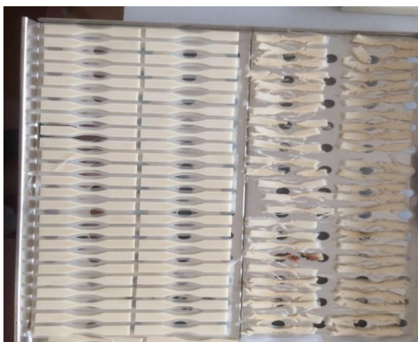
Obrázek 15 - Degradace materiálu PLA po jednom týdnu; ABS (levá strana) a PLA (pravá strana)
