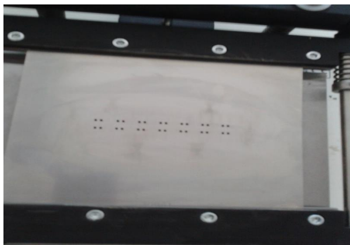
Obr. 19 Šablona uchycená v přístroji pro šablonový tisk
