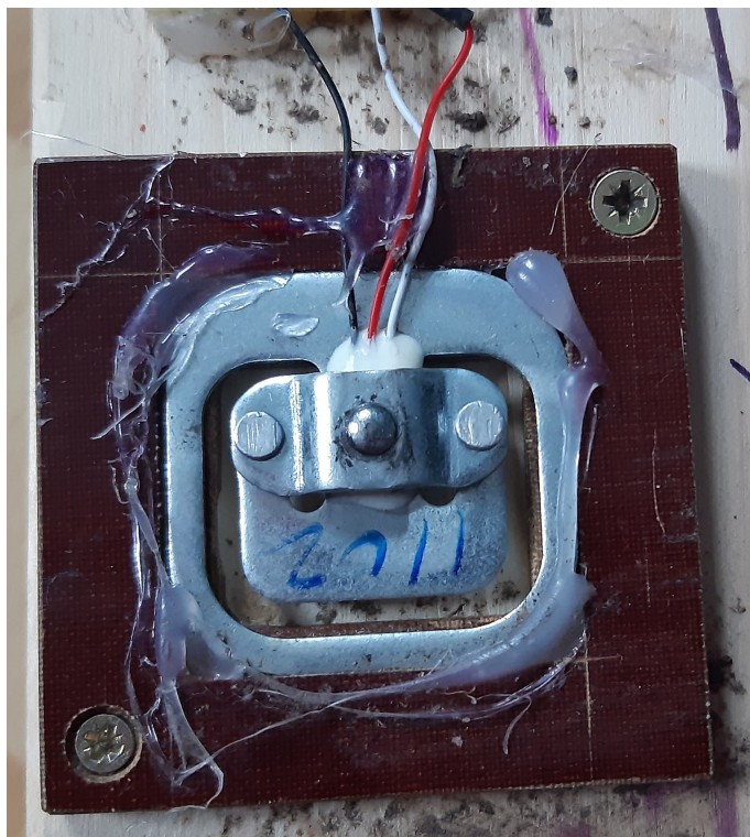
Obrázek 9.4. Uchycení váhového senzoru k přídatné desce
