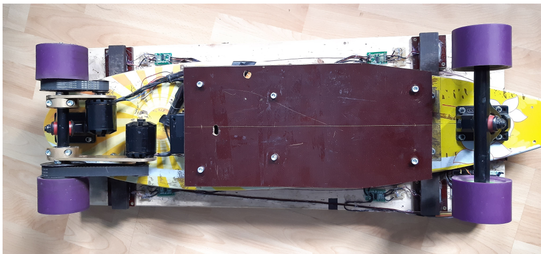
Obrázek 8.1. Prototyp longboardu s krytem elektroniky
