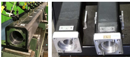
Obr. 7-2 Detail duralových vyztuží v místě podpory – a) zkušební těleso, b) reálná aplikace. Převzato z [D8].
