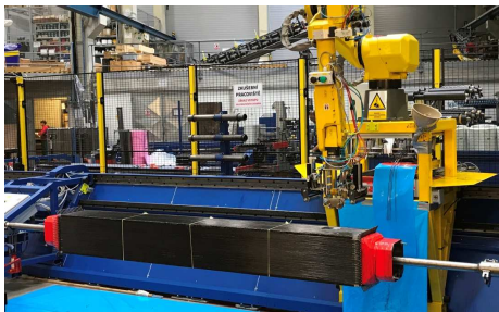
Obr. 1-1 Rozpracovaný nosník laserového plotru v robotickém navíjecím stroji firmy Compo Tech Plus s.r.o. Převzato z [E8].
