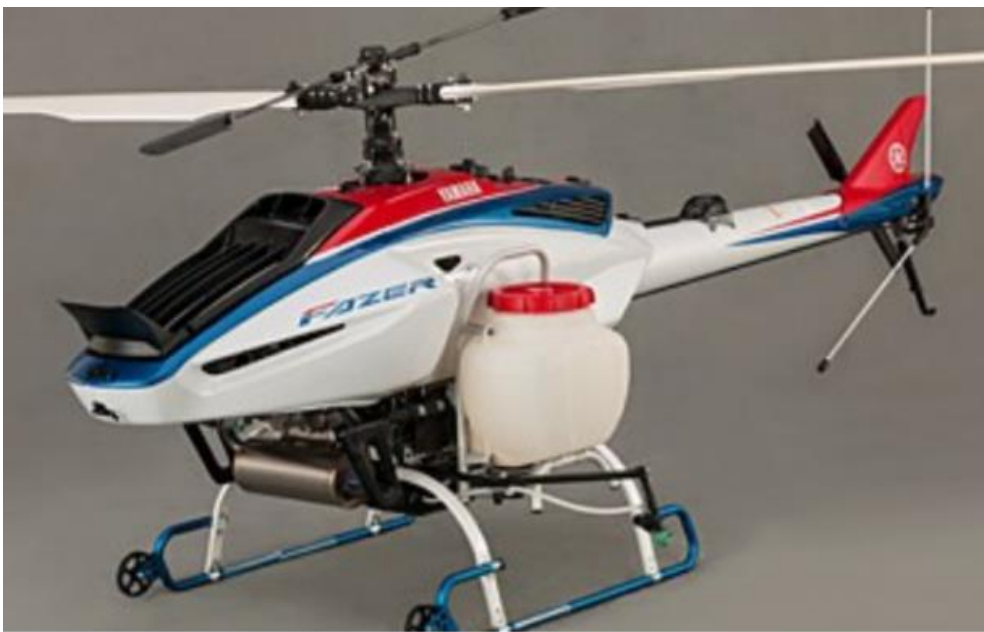
Obr. 7: Model vrtulníku často využívaný pro aplikaci pesticidů v přesném zemědělství. (Zdroj: Fialová, 2017).
