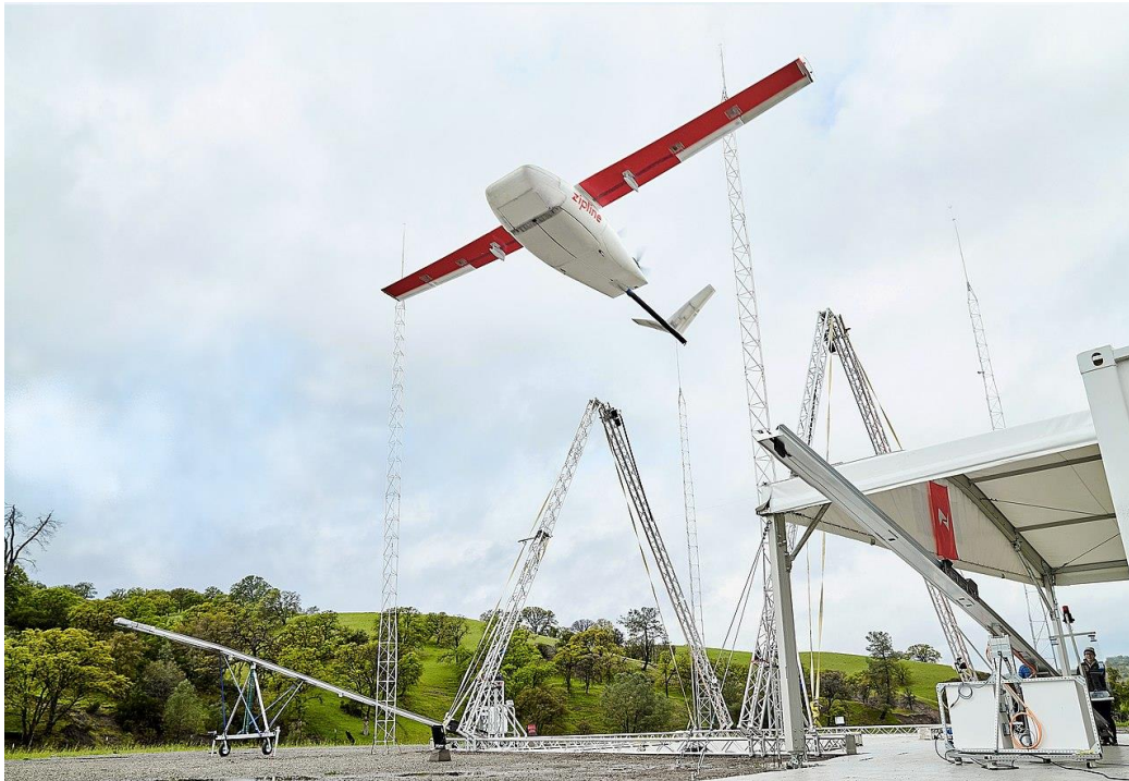
Obrázek 3: Bezpilotní letadlo společnosti Zipline při startu [16]
