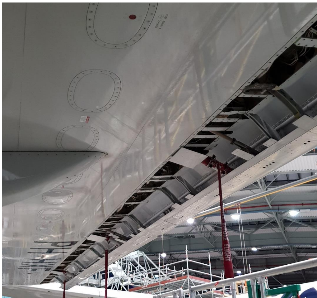
Obr.3 Príklad demontáže krycích panelov na krídle lietadla Boeing. (foto autor)
