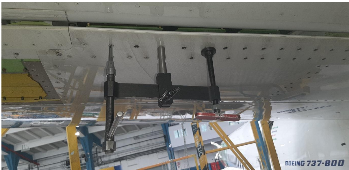
Obr.1 Príklad použitia náradia Extractor Assy tool, počas demontáže. (foto autor)
