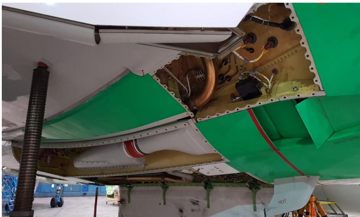
Obr.2 Príklad demontáže krycích panelov na trupe lietadla Boeing. (foto autor)
