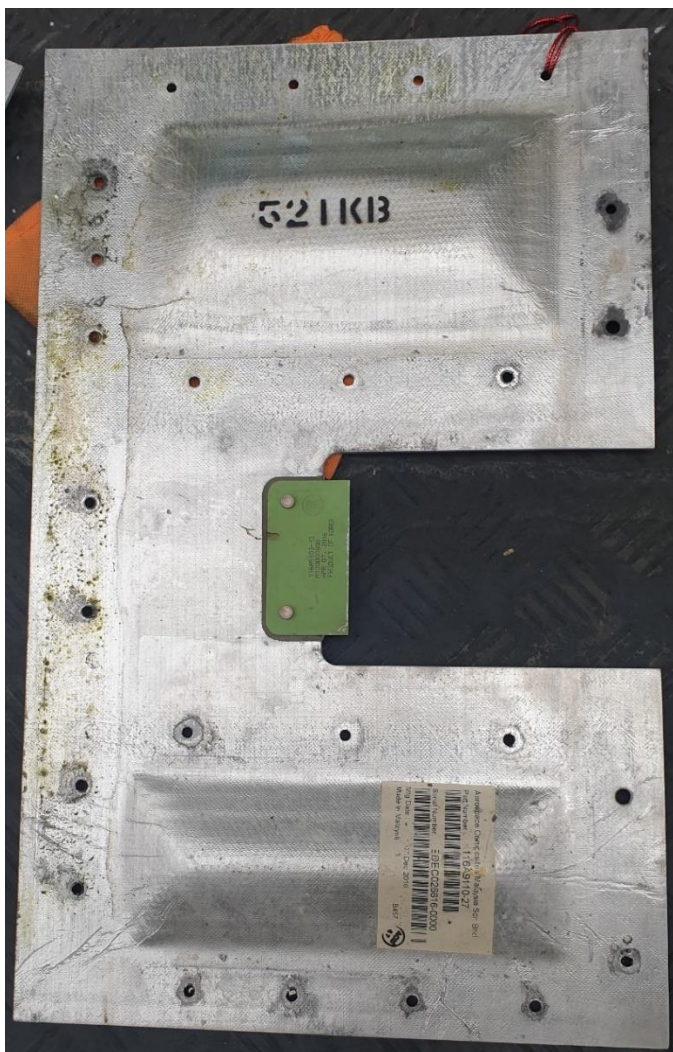
Obr.3 Ukážka prístupového panelu s identifikačným kódom. (foto autor)
