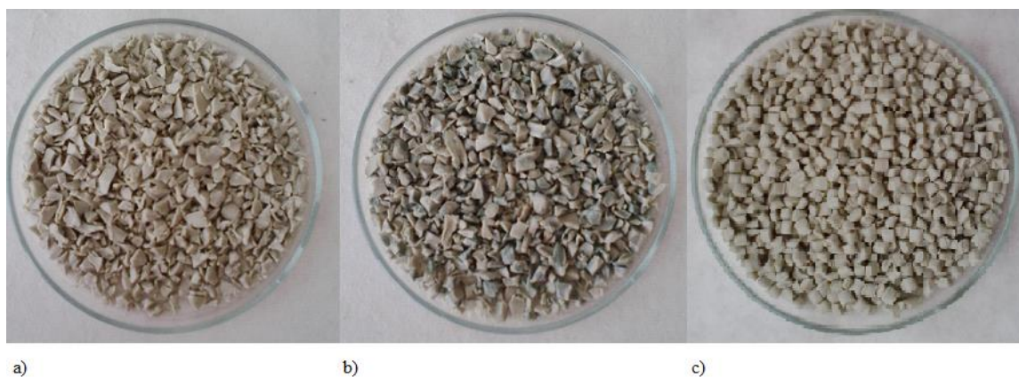
Obr. 7: Testované polypropylenové odpady: a) drcený PP-R, b) drcený PP-GF, c) regranulovaný PP-Reg
