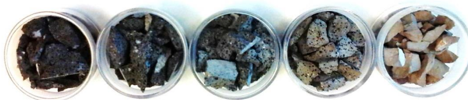
Obr. 33: Vzorky cementových past s náhradou cementu vypáleným a mletým říčným kalem, připravené na měření hustoty matrice; zprava: referenční vzorek, náhrada 10, 20, 30 a 60 % hmotnostních
