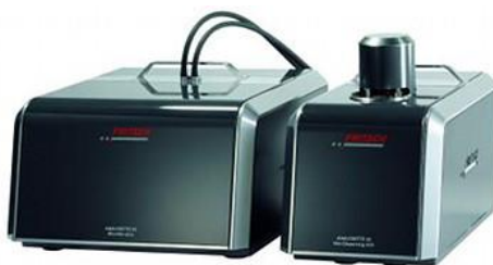
Obr. 40: Analyzátor distribuce velikosti částic Analysette 22 Micro Tec plus (Fritsch)
