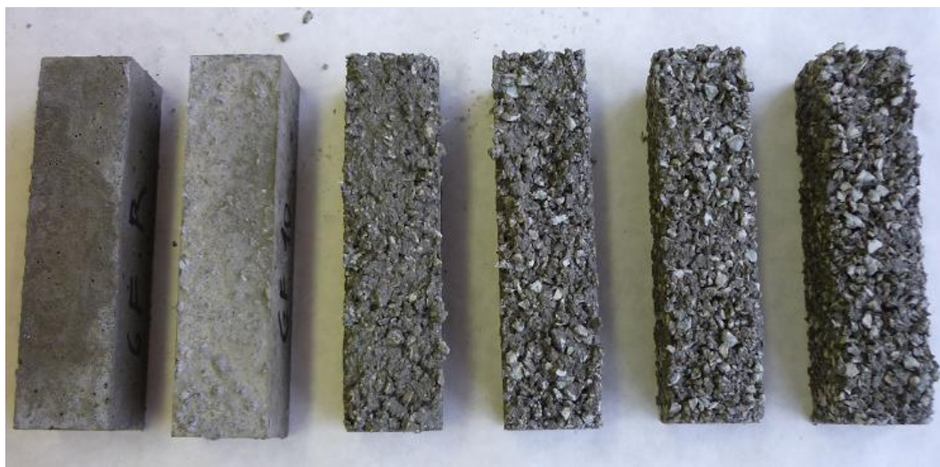
Obr. 30: Zleva – Trámeček s referenční záměsí a trámečky s náhradou písku 10–50 hmotnostních % PP-R
