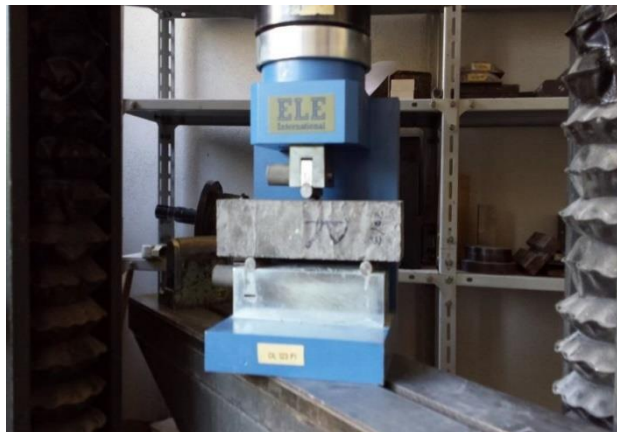
Obr. 35: Zkušební lis pro zkoušku pevnosti v tahu za ohybu
