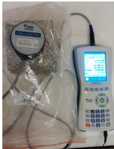
Obr. 42: ISOMET 2114 (Applied Precision s.r.o.) s plošnou sondou
