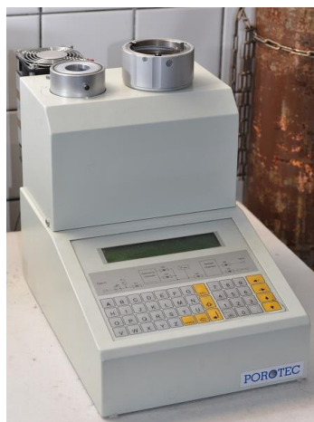
Obr. 39: Automatický héliový pyknometr Pycnomatic ATC
