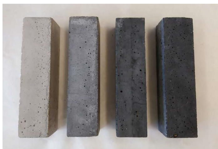
Obr. 34: Vzorky cementových kompozitů s přidavkem vypáleného a mletého polského kalu; zleva referenční vzorek, 10 - 30 % hmotnostních náhrada cementu kalem
