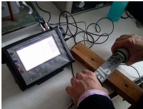
Obr. 37: Ukázka měření na ultrazvukovém impulsním přístroji DIO 562
