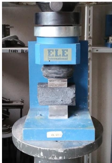
Obr. 36: Zkušební lis pro zkoušku pevnosti v tlaku
