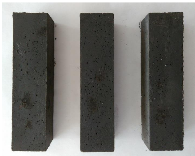
Obr. 32: Vzorky cementové pasty s náhradou cementu vypáleným mletým říčným kalem 60 % hmotnostních
