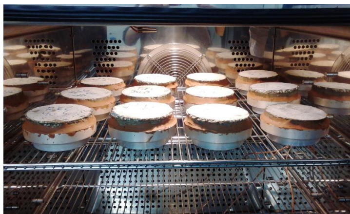
Obr. 44: Klimatická komora se vzorky pro měření transportu vodní páry
