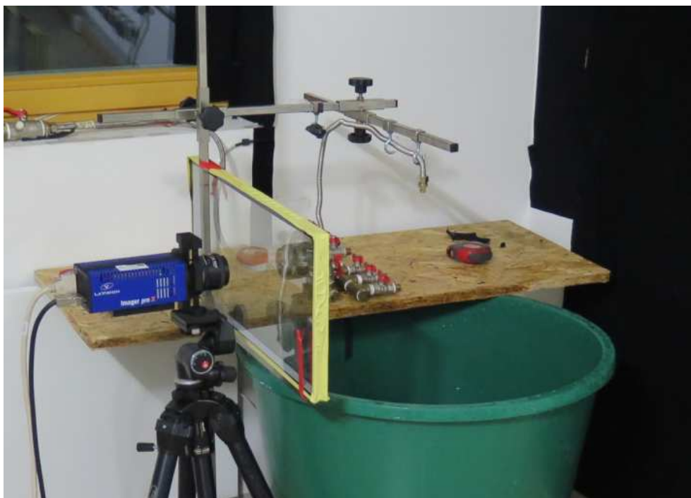
Obr. 50 – Měření rychlostního pole kapek za tryskou 490.406.30.
