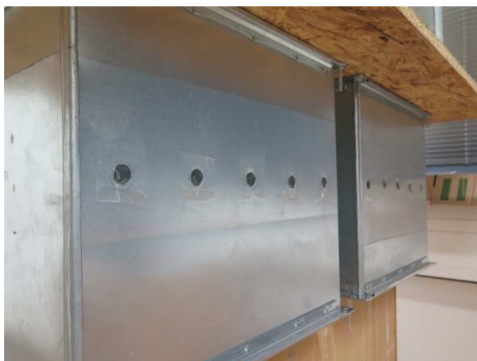
Obr. 43 – Vlevo: díl pro sondáž rychlostního profilu. Vpravo: rychlostní profil EHA (m/s)
