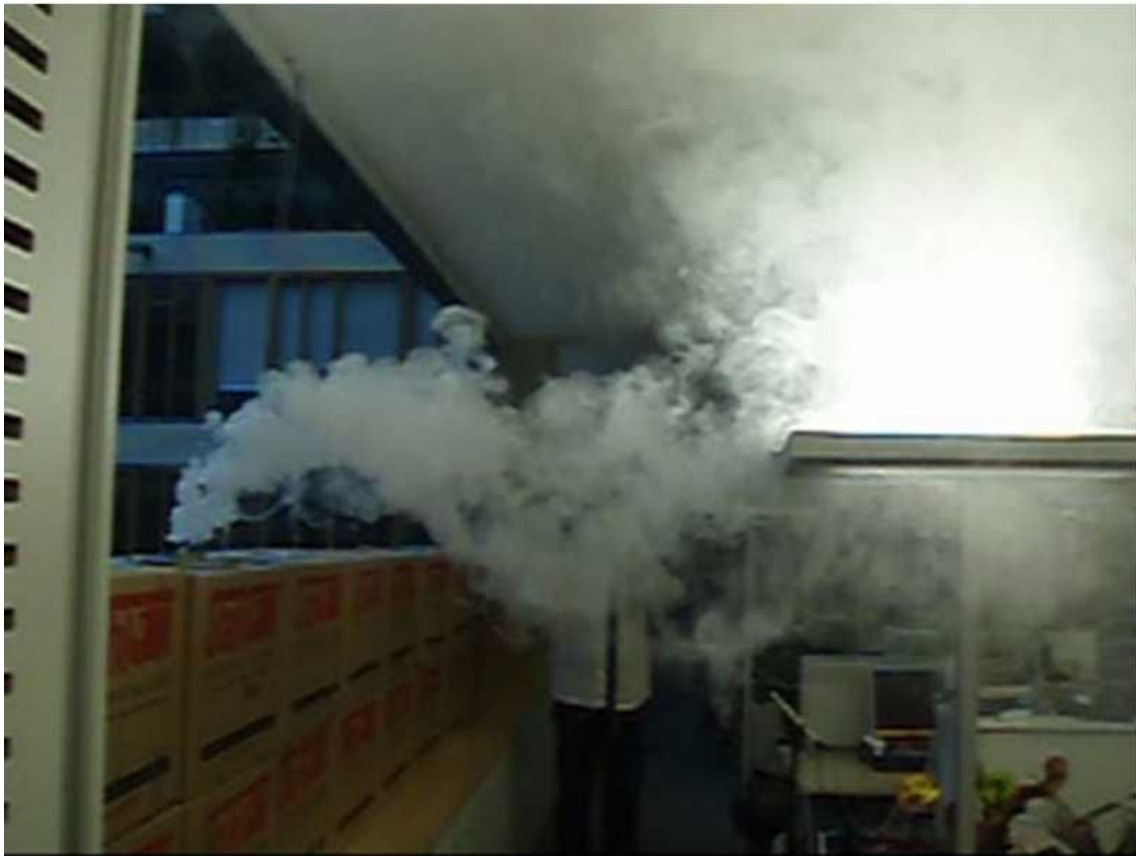
Obr. 51 Kouřové zkoušky se zvýšeným parapetem
