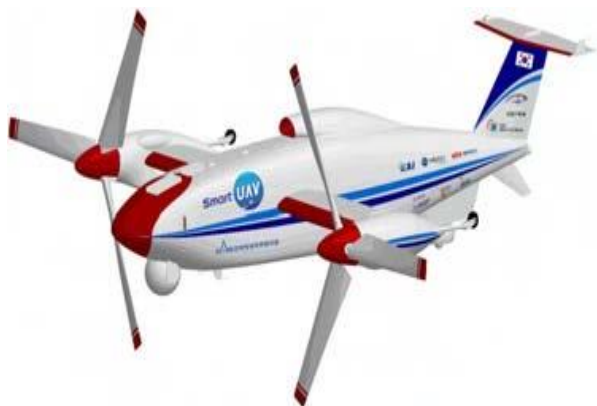
Obrázek 3 - Konvertoplán – Otočné pohonné jednotky [17]
