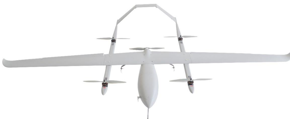
Obrázek 5 - Konvertoplán – Dvojité provedení [19]
