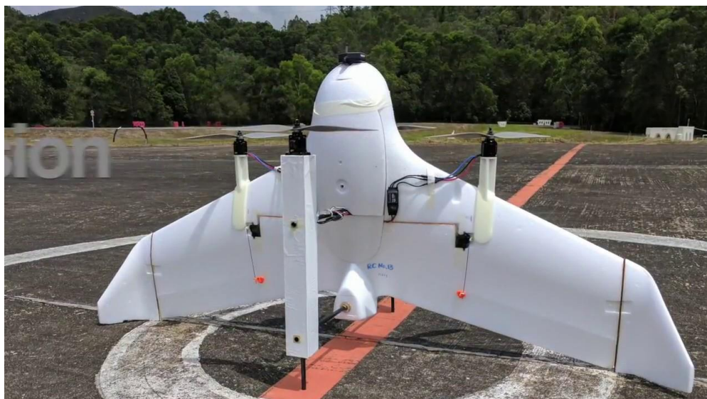
Obrázek 7 - Hybridní letoun s přistávacím zařízením v ocasní části [21]
