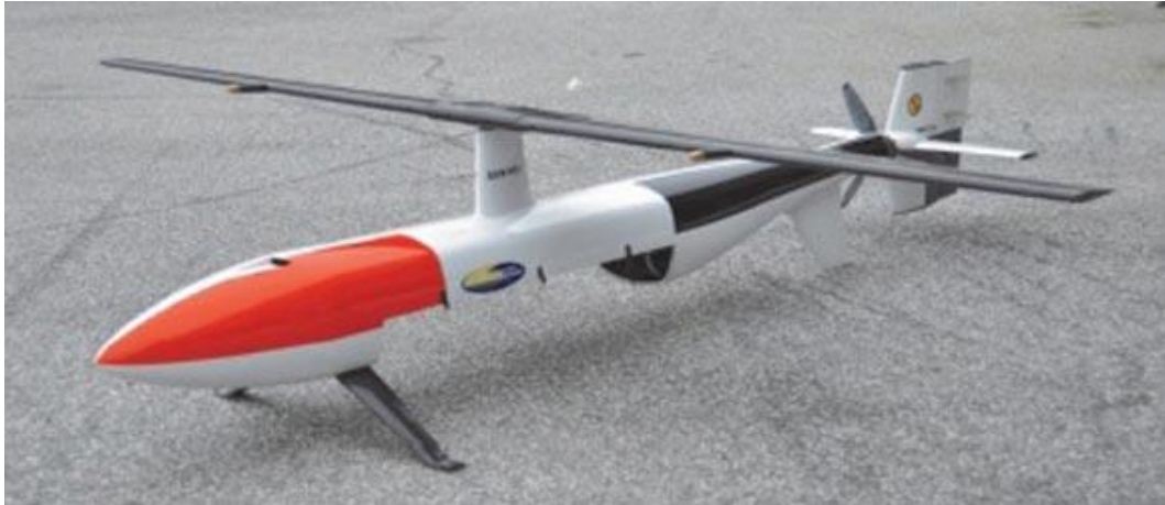
Obrázek 6 - Konvertoplán – Rotorové křídlo [20]
