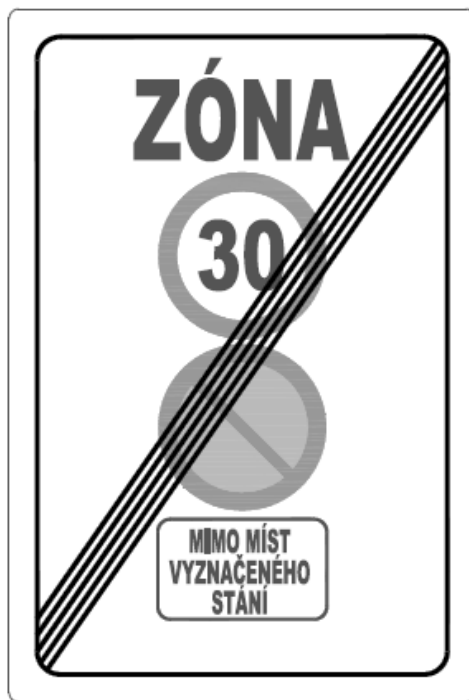
Obrázek 23 - dopravní značky IZ8a „Zóna s dopravním omezením“ a IZ8b „Konec zóny s dopravním omezením“ použité v současnosti
