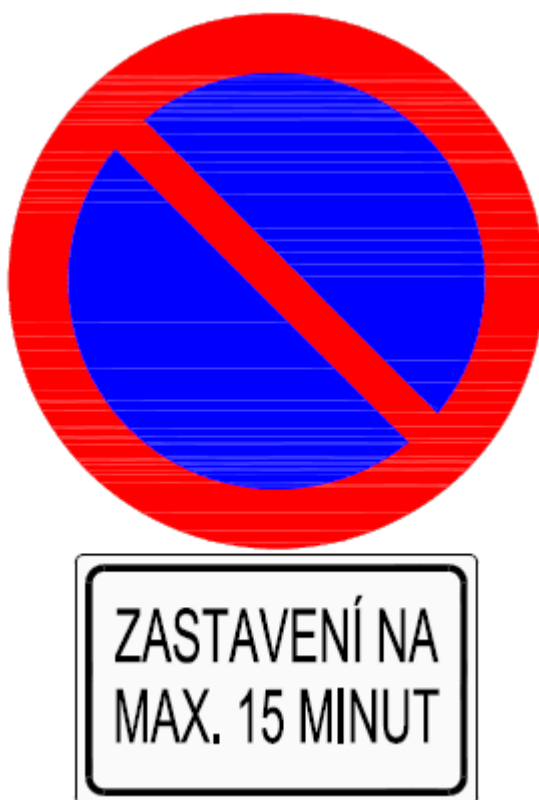
Obrázek 111 - dopravní značka B29 "Zákaz stání" s dodatkovou tabulkou E13 "ZASTAVENÍ NA MAX. 15 MINUT"
