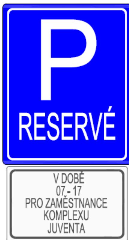
Obrázek 113 - dopravní značka IP12 „Vyhrazené parkoviště“ s dodatkovou tabulkou E13 „V DOBĚ 07 – 17 PRO ZAMĚSTNANCE KOMPLEXU JUVENTA“ - možná podoba dopravní značky upravující charakter provozu parkovacích stání pro komplex Juventa
