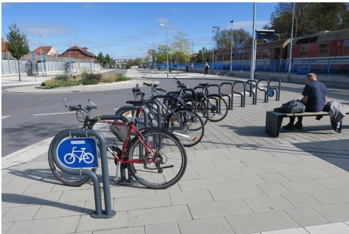
Obr. 5.1: Příklad správného provedení stojanů ve tvaru písmene P v Třebíči.
