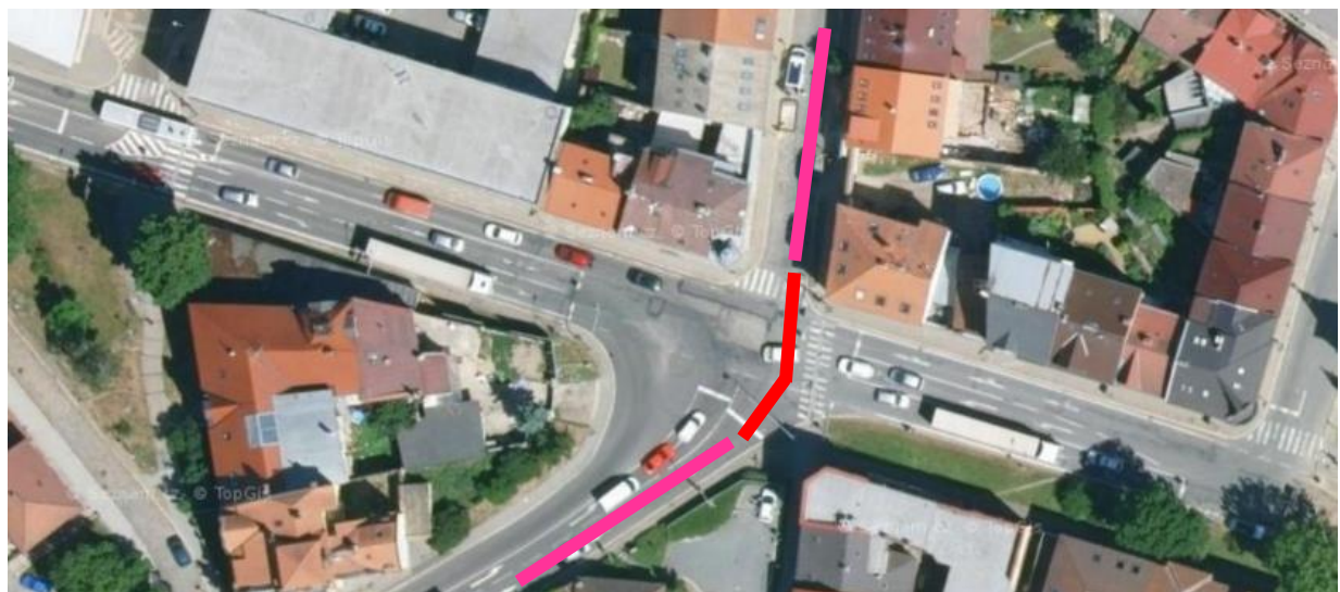
Obr. 4.10: Schéma nedostatečného propojení (červeně) růžových stávajících cyklistických tras v křižovatce Nádražní, Bráfova tř. a Jungmanova. [mapový podklad 13]
