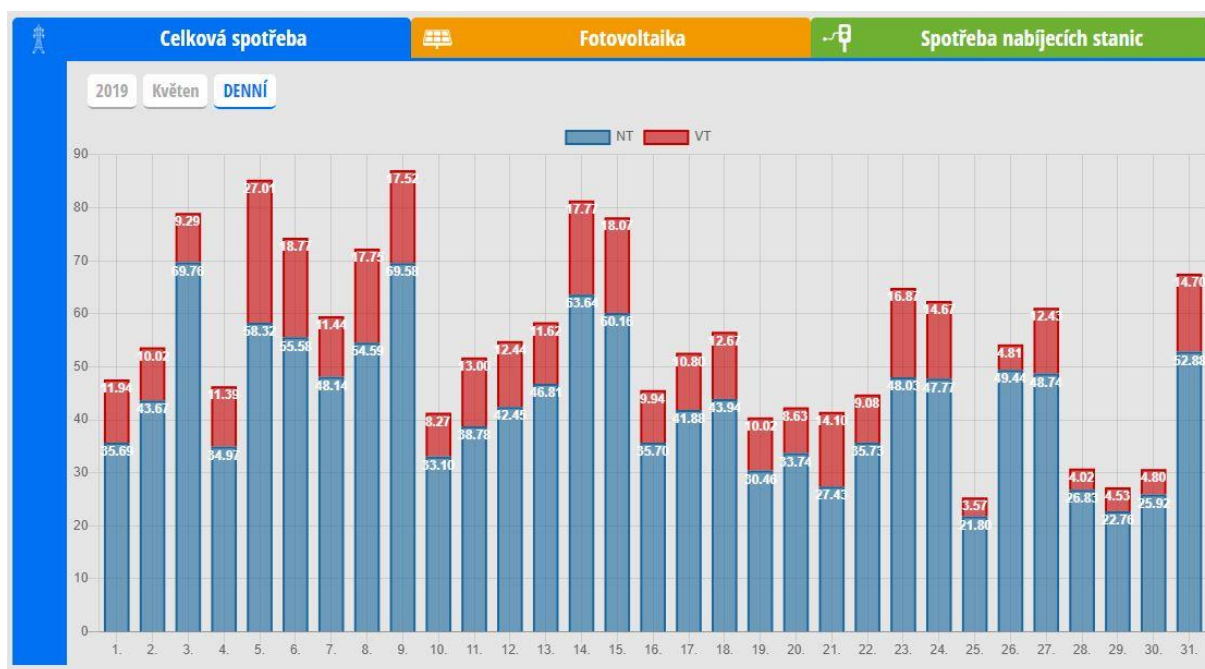
Obrázek 15 - Celková spotřeba domácnosti v průběhu měsíce (zdroj: moje.smartev.cz)
