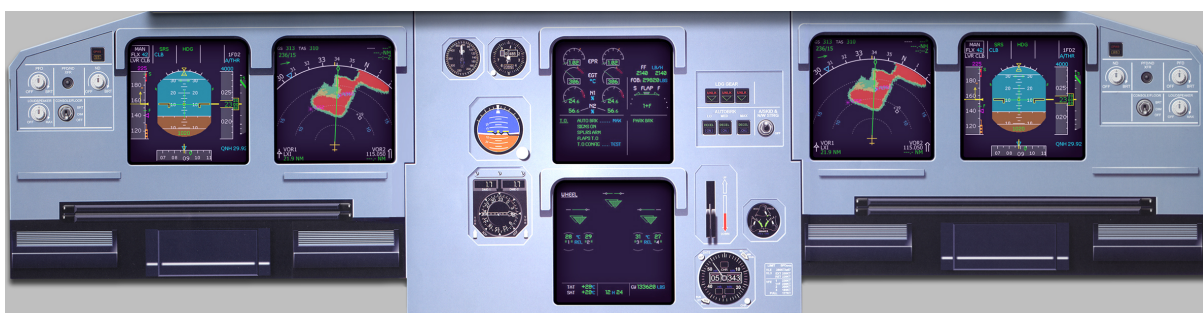
Obrázek č.7 Main Instrument Panel (MIP) [9]
