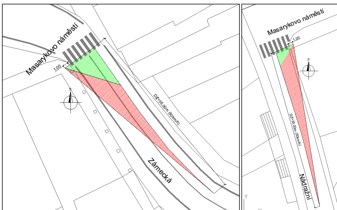
Obrázek 22 – Nesprávné umístění přechodu 1
