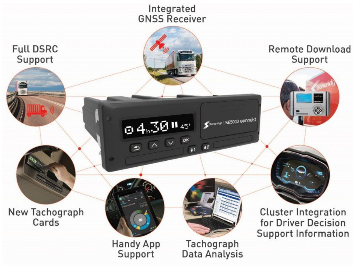
Obrázek 24: Princip fungování inteligentního tachografu Stoneridge [10]
