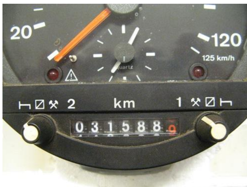
Obrázek 6: Detail přepínače pracovních pozic řidiče [14]
