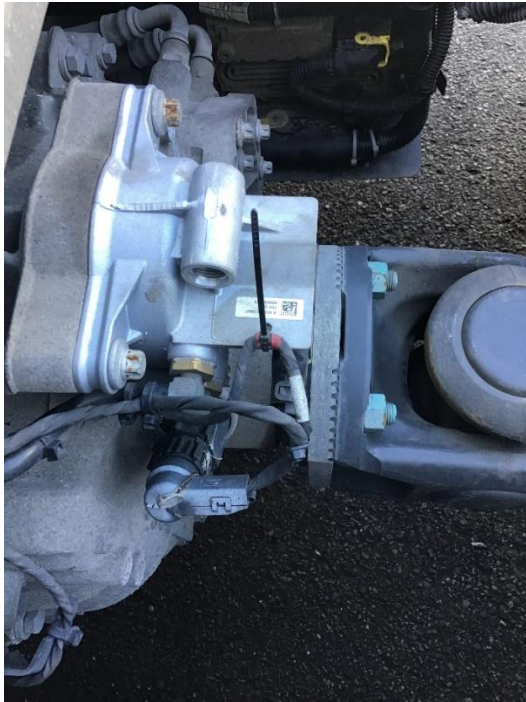
Obrázek 19: Zaplombování snímače pohybu
