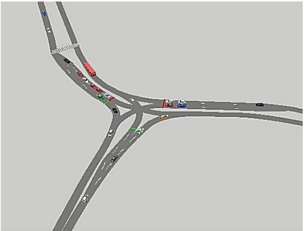
Obrázek 17: Simulace VISSIM nová situace řízené křižovatky ranní špička, fáze 3
