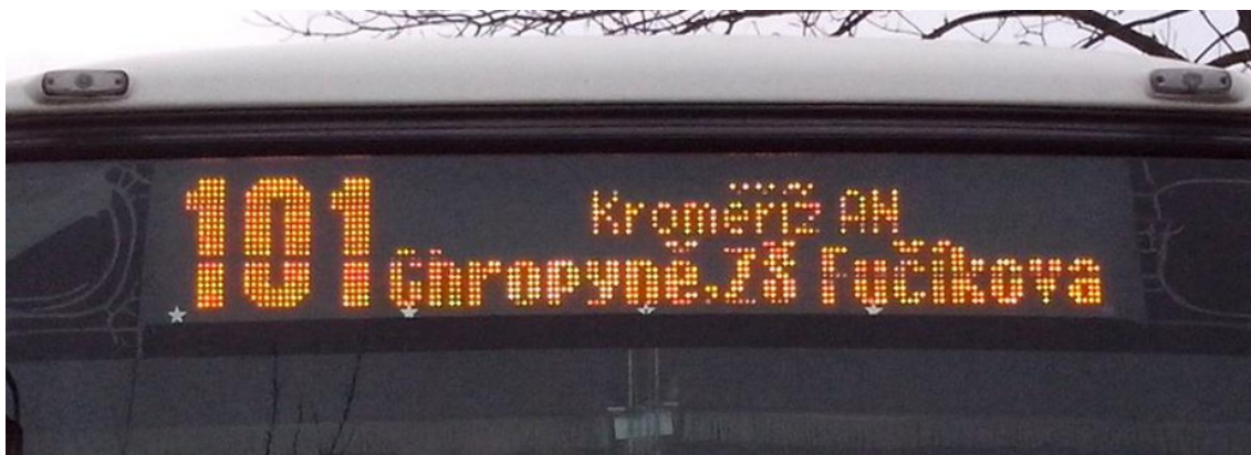
Obrázek 2: textový mód zobrazovacího panelu EmTest (Daniel Kelnar, 2015)
