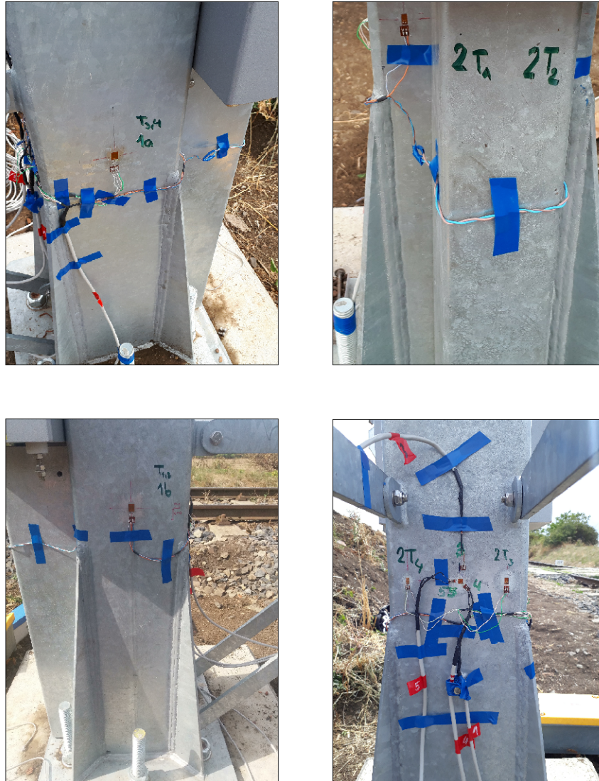
Obrázek 12: Fotografie tenzometrických míst na stožáru. Rozmístění odpovídá schématickému znázornění na obrázku 11
