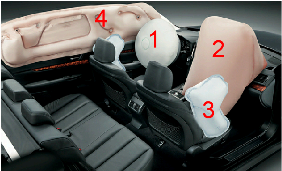
Obrázek 10 Rozmístění airbagů ve vozidle [12]
