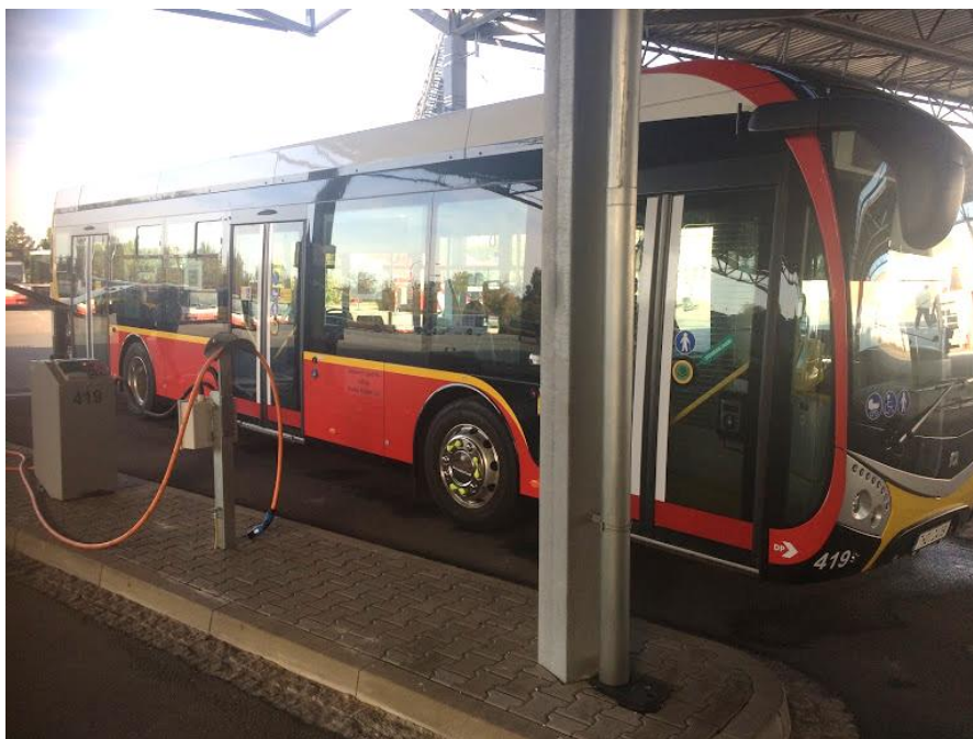
Obrázek 6 - Nabíjení elektrobuse v prostoru vozoven Dopravního podniku Hradce Králové, foto autor
