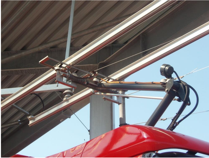
Obrázek 5 – Způsob nabíjení elektrobuse v areálu vozoven DPMCB, foto autor
