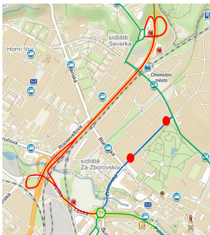
Obrázek 1 - Přesun trolejového vedení ze silnice I/13 do ul. Zborovská s dvěma novými zastávkami [3]
