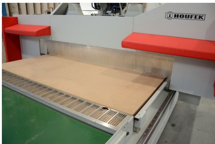
Obrázek 8 - Ochranné nárazníky a zástěrky obráběcího stroje Scorpion výrobce Houfek a.s. [28]
