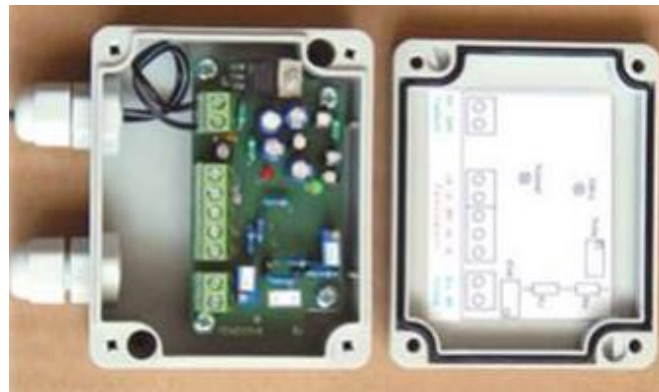
Obrázek 4.28 Deska plošného spoje tenzometrického převodníku v plastovém krytí [34]
