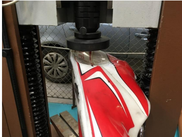
Obrázek 3.28 OTK při vertikální tlačné zkoušce [1]
