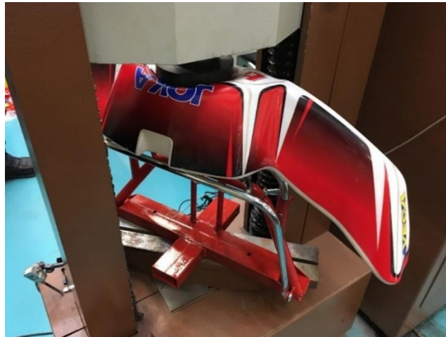
Obrázek 3.29 KG nárazník při vertikální tlačné zkoušce [1]
