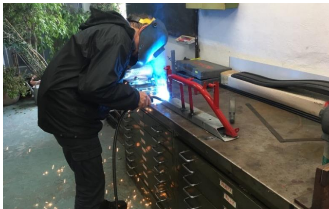
Obrázek 3.7 Svařování přední části rámu s podstavou [1]
