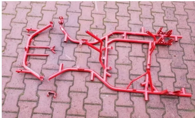
Obrázek 3.6 Uřezání přední části podvozku [1]
