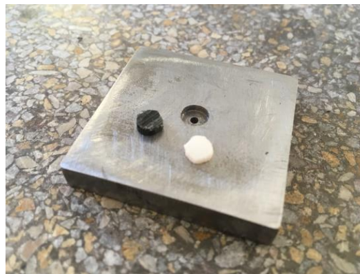
Obrázek 3.30 Vzorky materiálu pro DSC [1]
