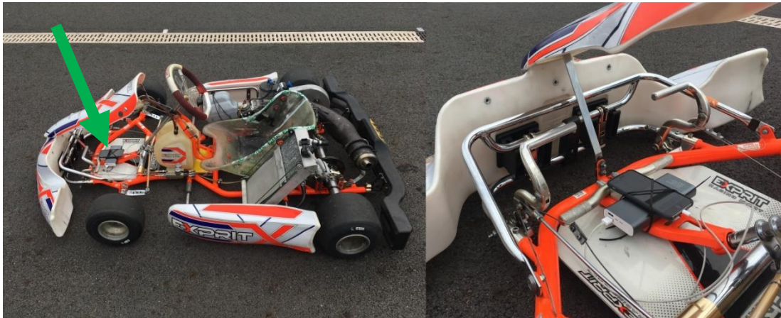
Obrázek 2.7 Umístění a detail uchycení akcelerometru na motokáře [1]
